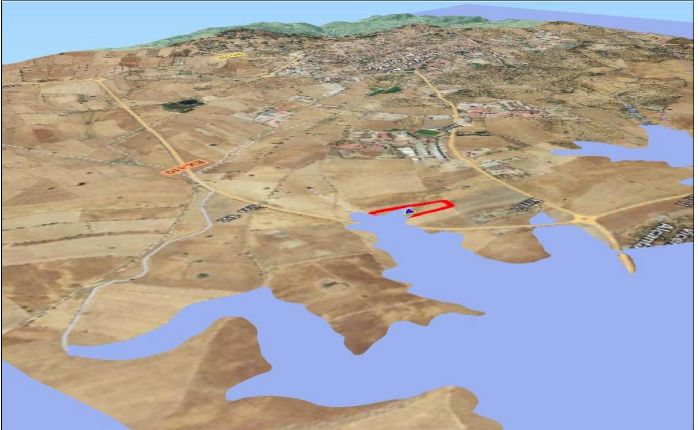
Figura 10 Análisis del riesgo de inundación y su efecto sobre la balsa, para darse el caso de riesgo de rotura por inundación el límite de cota obtenido es el 438 msnm, a partir del cual el agua llegaría a pie de balsa. Este caso se considera extremo debido a que por las características de la red de drenaje así como por la altura de la planta respecto al terreno, la posibilidad de esta inundación se considera nula.
