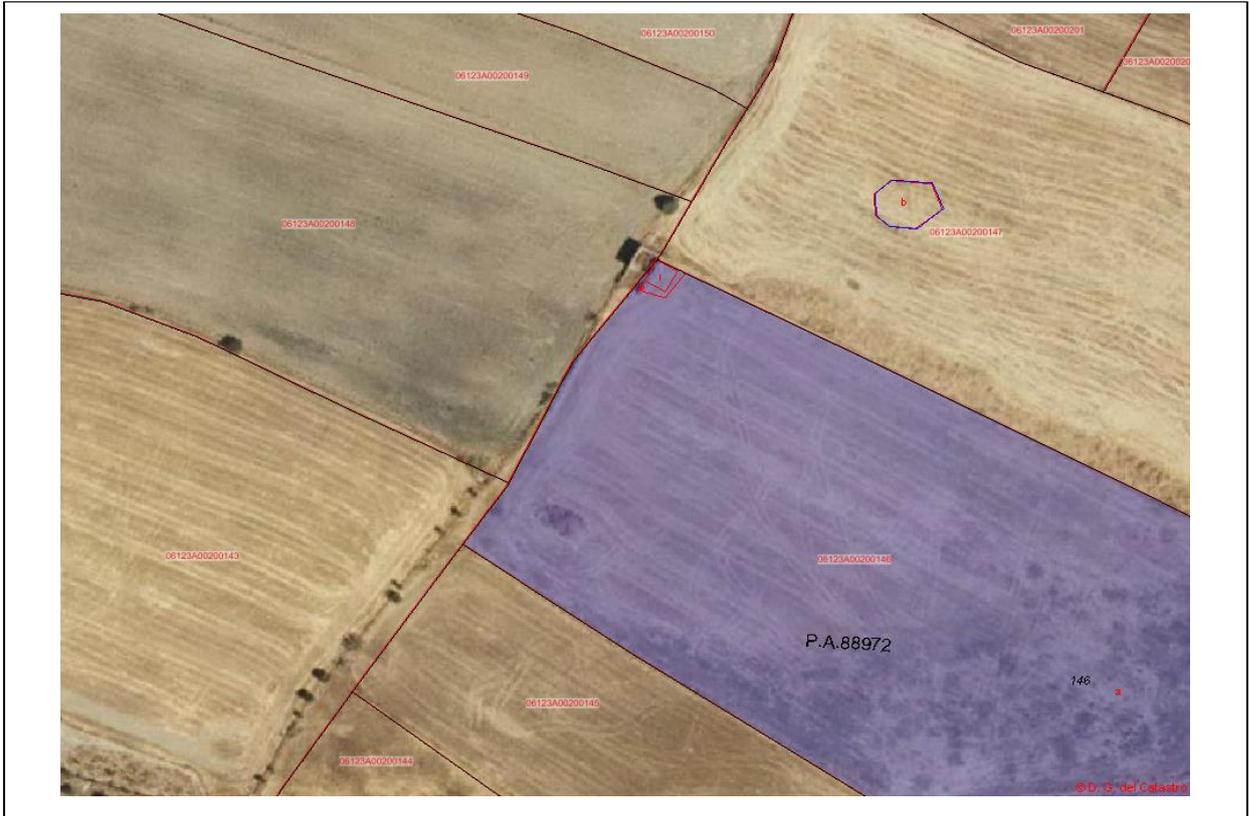
*Figura 2 Plano catastral del área con la ortoimagen actual del PNOA de base donde podemos apreciar la pequeña construcción delimitada en la parcela catastral aunque por una desviación del límite de la parcela esta construcción se ubica fuera de la parcela catastral. Situación similar sucede en el límite Este, donde parte de la parcela catastral ocupa el camino.*
